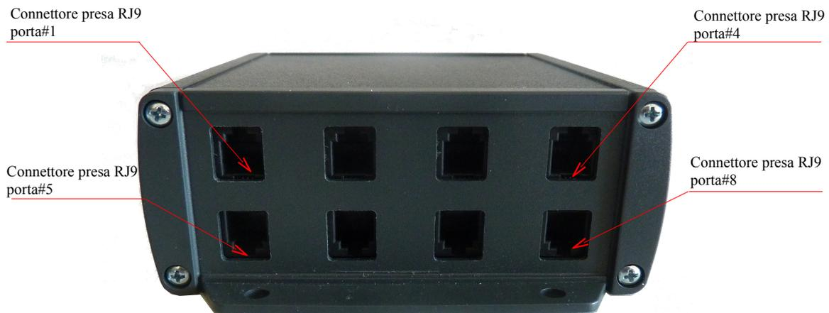
Figura 2 Centralina del sistema di acquisizione per misure di temperatura ed umidità tramite sensori digitali (nella foto è evidenziata la numerazione delle porte relative alle 8 prese RJ9 per la connessione con i sensori digitali)
